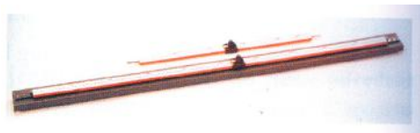
Слика 32: Витстоновиот мост е лабораториски отпорник со чија помош се определуваат непознати отпори
