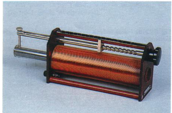
Слика 12: Кај соленоидот винтот служи за постапно внесување и изнесување на јадрото од меко железо
