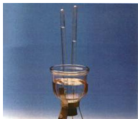
Слика 82: Електролиза на вода. Пропуштена струја низ електролитот довела до издвојување на кислород во десната цевка и на водород во левата
