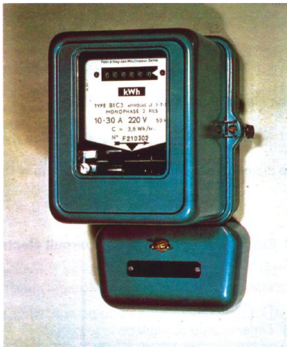
Слика 35: Покрај класичните електрични бројачи, постојат и електронски. И кај едните и кај другите потрошената енергија се мери во килватчасови ( kWh )
