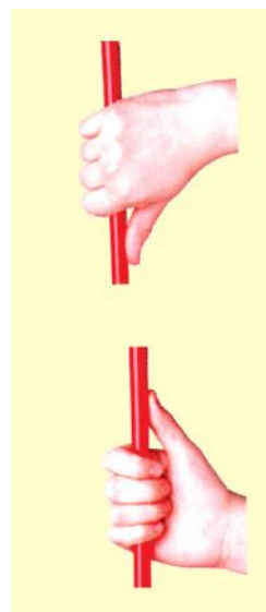
Слика 2: Правилото на десна рака е применливо за секој проводник, со било каква форма, кога низ него тече струја
