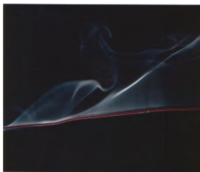
Слика39: Низ тенката жица поминала струја која ослободувајќи топлина ја загреала до вжестување така да гори нејзината изолација
