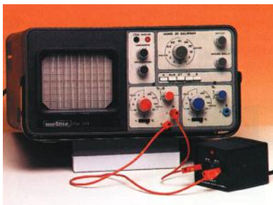
Слика 9: Генератор на наизменичен напон е врзан на влезот А на осцилокопот
